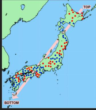
日本全国での地震発生状況を俯瞰するため、日本全国から選び出した100箇所のHi-net観測点での記録を画像化しました。1枚の波形画像に1時間分の地動が記録されています。1本のトレースは、ある観測点の1時間分の波形を表しており、横軸の数値は分を表します。観測波形は、北（北海道）の観測点から南（九州の観測点）の順で、上から下に並べてあります。左に選んだ観測点の位置を示します。最上部の10観測点の位置を赤丸、次の10観測点を青丸、さらに次の10観測点を赤丸といったルールで表示しています。
